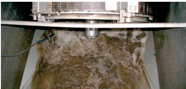
久经考验的 ROTAMAT® 过滤装置 Ro 2 进行污水精细过滤处理
